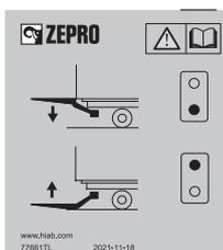
Figura 86. Etiqueta del dispositivo de mando para CD 10
