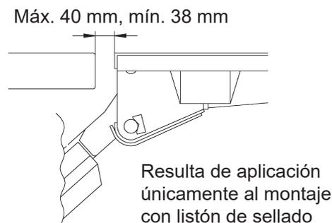
Figura 35. Comprobar la posición en relación con la barra trasera del vehículo
