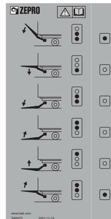
Figura 68. Etiqueta del dispositivo de mando para CD 1, 2, 9
