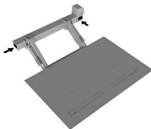
Obrázek 2. Umístění na zdvižném čele s max. zatížením rovnajícím se nebo vyšším než 1000 kg.
