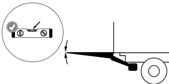
*Avant d'utiliser la fonction de basculement automatique, assurez-vous que la plate-forme soit vraiment horizontale*
