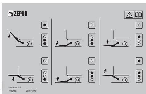
Autocollant de l'actionneur CD 1 avec le bouton de commande à deux mains monté au-dessus de l'actionneur.
