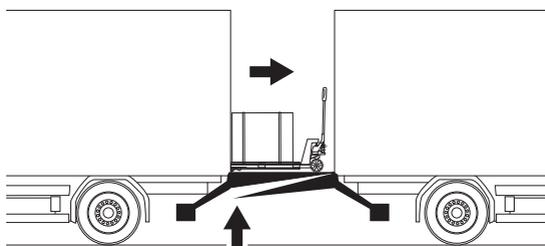
L'extrémité de la plateforme du véhicule récepteur doit toujours être dégagée
