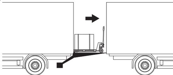
Poids de transfert maximal = Capacité de charge du hayon élévateur x 0,5
