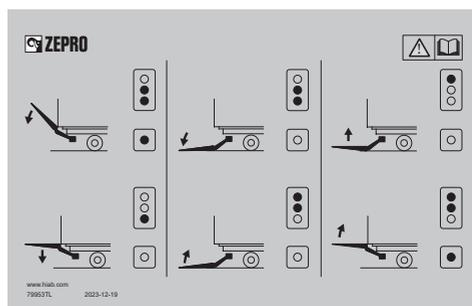
Autocollant de l'actionneur CD 1 avec le bouton de commande à deux mains monté sous l'actionneur.
