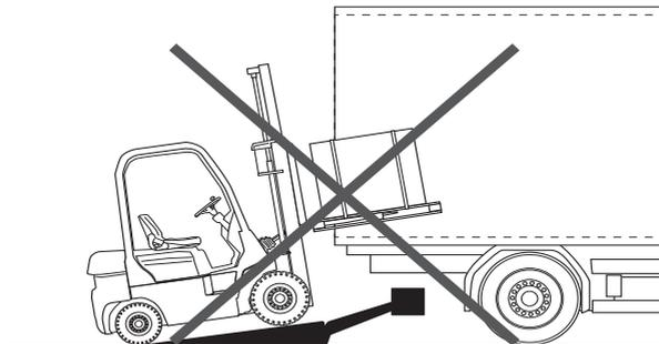
Il est interdit de faire rouler un chariot élévateur sur la plate-forme
