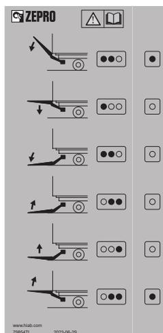
Autocollant pour commande CD1, CD 9 et CD 18. L'autocollant est composé de deux parties. La bande étroite n'est utilisée qu'avec les actionneurs CD1.
