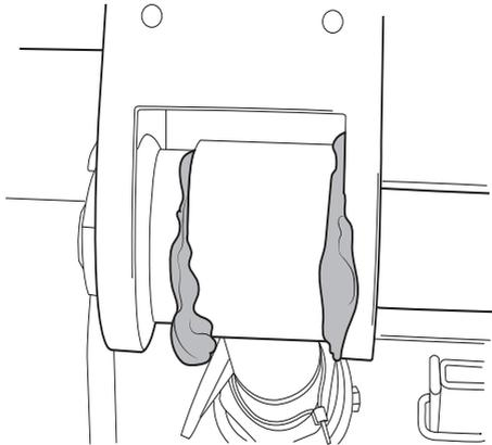
*La lubrification doit être effectuée de manière à ce qu'un collier de graisse soit visible des deux côtés des paliers.*
