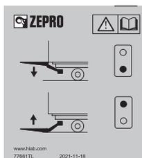
Abbildung 90. Bedienfunktionsaufkleber für CD 10
