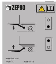
Abbildung 82. Bedienvorrichtungsaufkleber für CD 10
