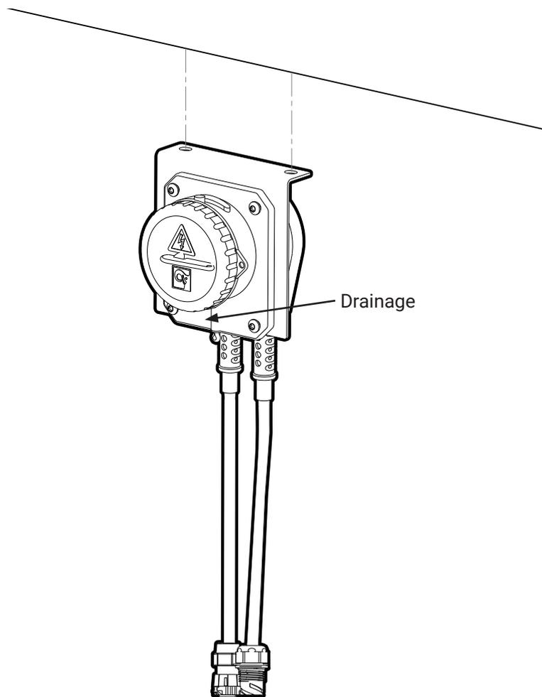
Figure 57. Installation de l'interrupteur principal
