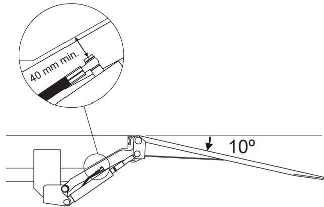
Figure 5. Distance de garde d'au moins 40 mm par rapport à la partie la plus rapprochée du vérin
