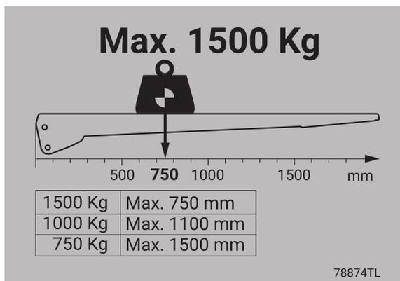
Figure 72. Charge maximale autorisée pour la capacité de charge 1500 kg, distance du centre de gravité 750 mm.
