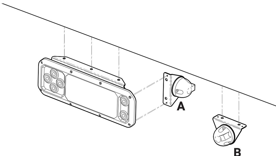
Figure 51. Montage de l'actionneur portable CD 19 et contact pour l'actionneur portable
