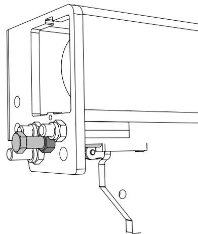
Figure 26. Vis de réglage de la position de travail
