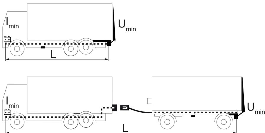
Figure 54. Consommation électrique maximale - Section minimale recommandée
