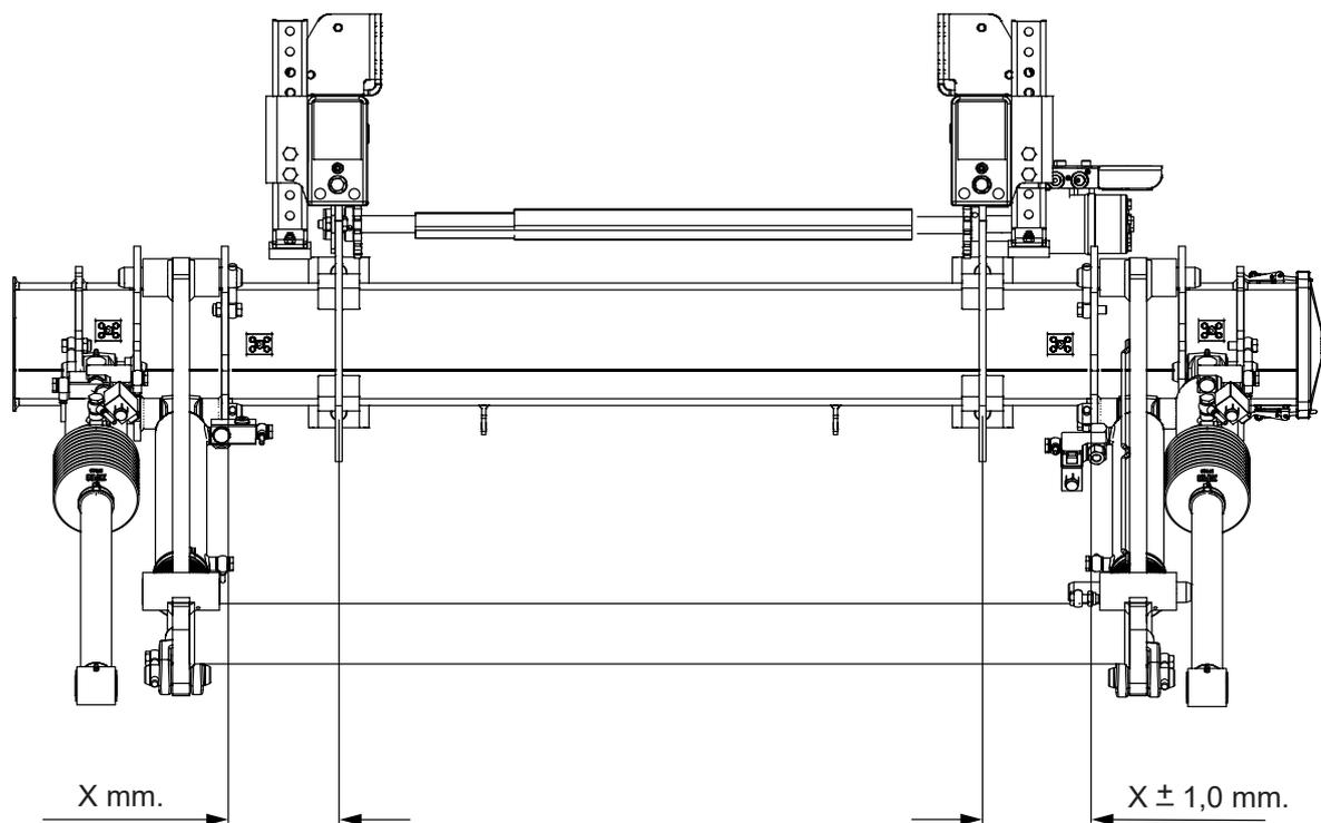
Figure 23. Ajustement des supports de cadre
