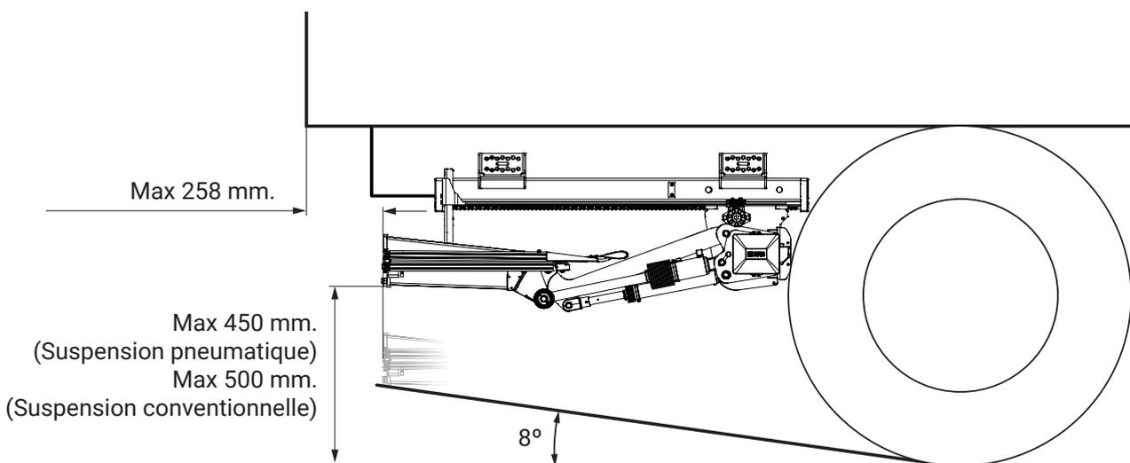
Figure 8. Cotes réglementaires pour la protection anti-encastré
