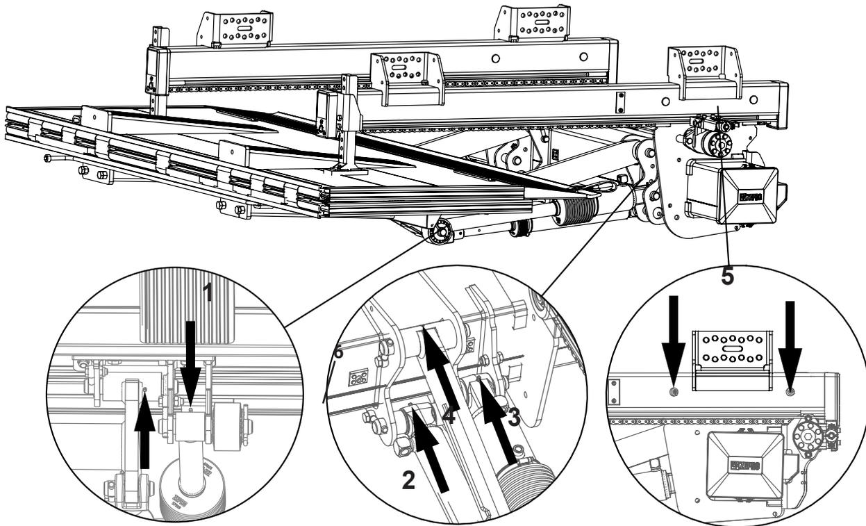
Figure 70. Points de graissage
