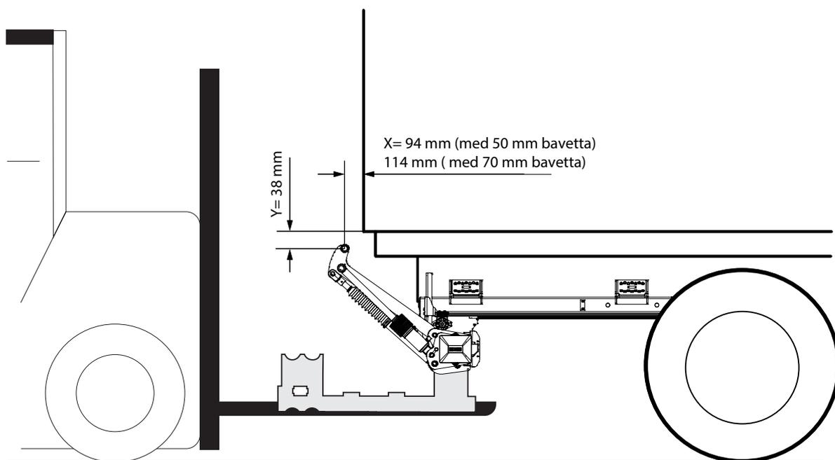
Figure 24. Montage de l'ossature de l'élévateur en position de travail
