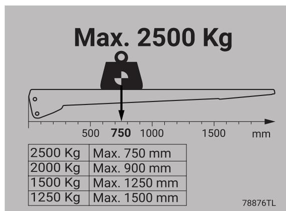
Figure 74. Le diagramme de charge pour la capacité de charge 2500 kg, distance du centre de gravité 750 mm.
