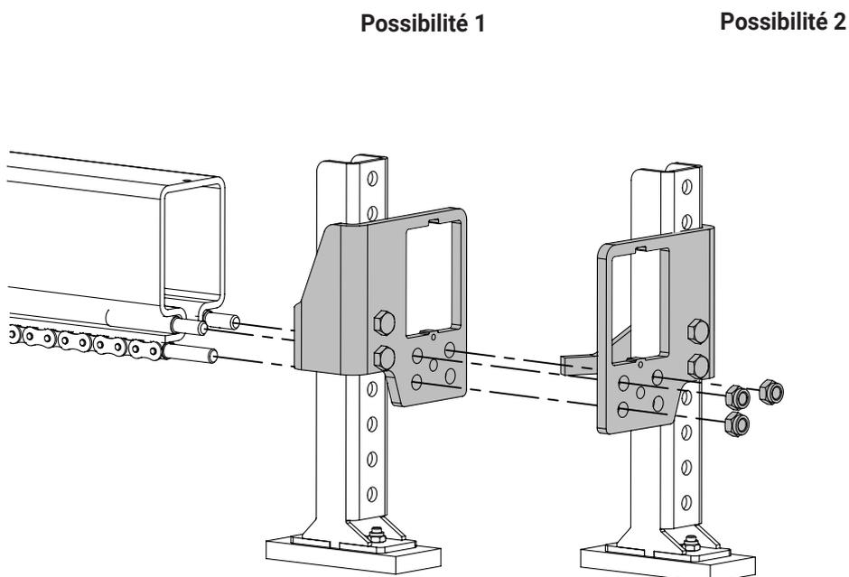
Figure 37. Autre possibilité de montage des butées de transport
