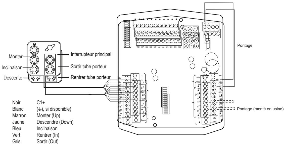
Figure 22. Connexion temporaire du boîtier de commande
