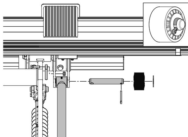
Figure 33. Montage du vérin d'inclinaison sur la plate-forme
