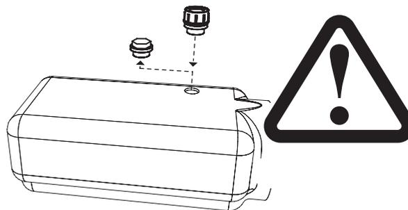
Figure 20. Le cas échéant, remplacez le bouchon de transport par le bouchon de remplissage ordinaire.
