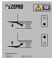
Figura 82. Etiqueta del dispositivo de mando para CD 10
